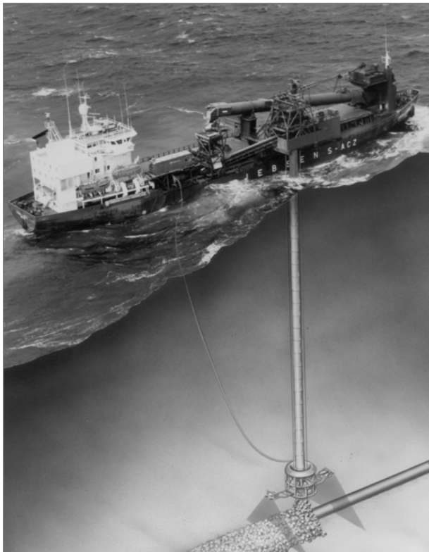
Figure 1.10 Protection en enrochements des conduites mise en œuvre à l'aide d'un tube plongeur (d'après CUR, 1995, source : Van Oord nv)
