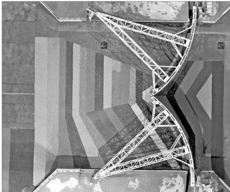
Figure 5.120 Vue de dessus de l'installation utilisée pour évaluer la stabilité de la protection du fond du barrage anti-tempête de Maeslant, aux Pays-Bas (réalisation : WL | Delft Hydraulics pour le Maeslantkering et le Rijkswaterstaat)
