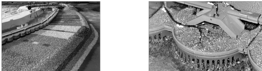
Figure 5.119 À gauche : modèle physique 3D d'un projet de protection côtière complexe destiné au District Central de Beyrouth, comprenant notamment une digue immergée et des caissons. À droite : détail des capteurs de pression installés sur l'un des caissons.
