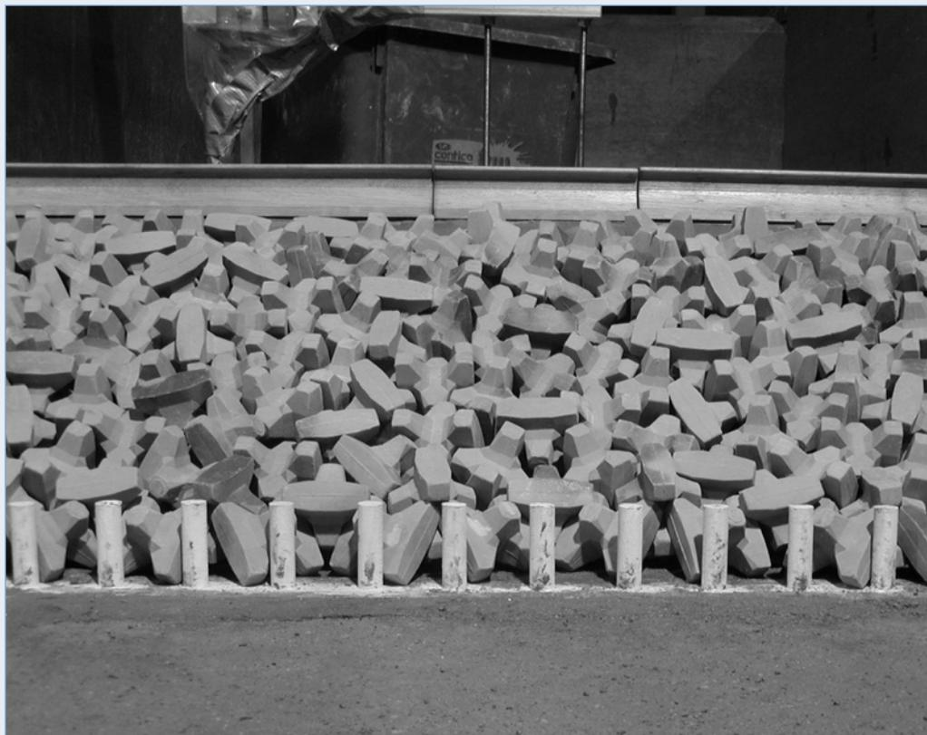
**Figure 6.20** Vue des essais physiques d'un pied en pieux béton (source : HR Wallingford)
