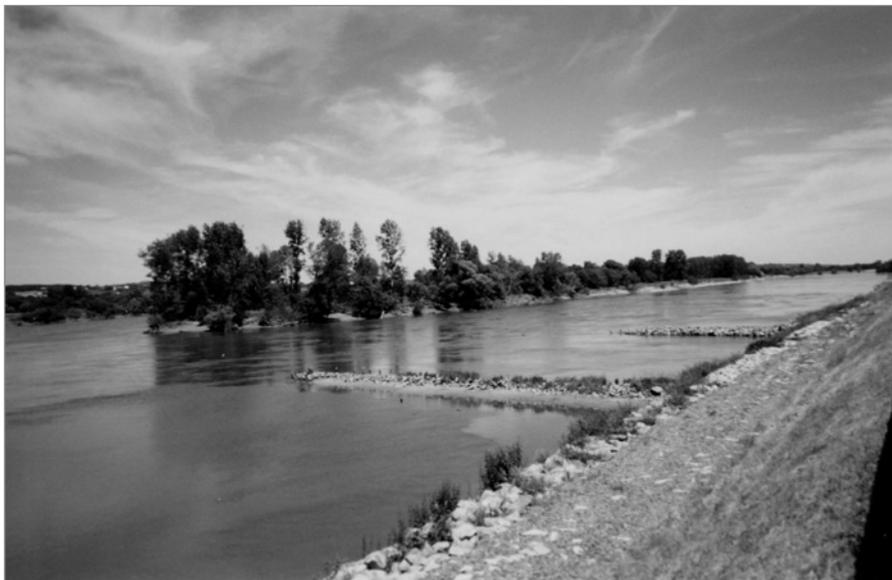
**Figure 8.11** Système d'épis sur la Loire (source : Service Maritime et de Navigation de Nantes)
