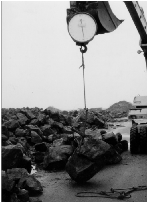
Figure 3.42 Cliché d'un capteur de force et d'un peson à ressort (source : G. Laan)
