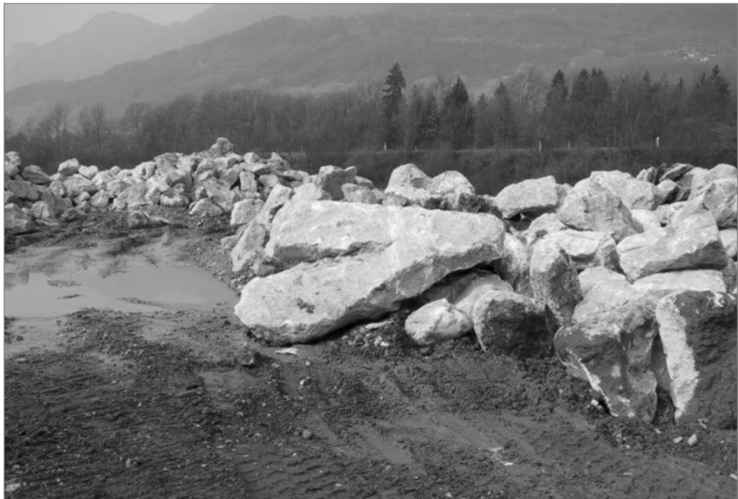
Figure 3.87 Vue d'un stock temporaire de 1 000-3 000 kg pour lequel le contrôle qualité est inadéquat (source : S. Dupray). Les livraisons contiennent des blocs dont la forme et la masse ne conviennent pas. Les différentes catégories d'engrènement sont à peine séparées et identifiées sur le site.
