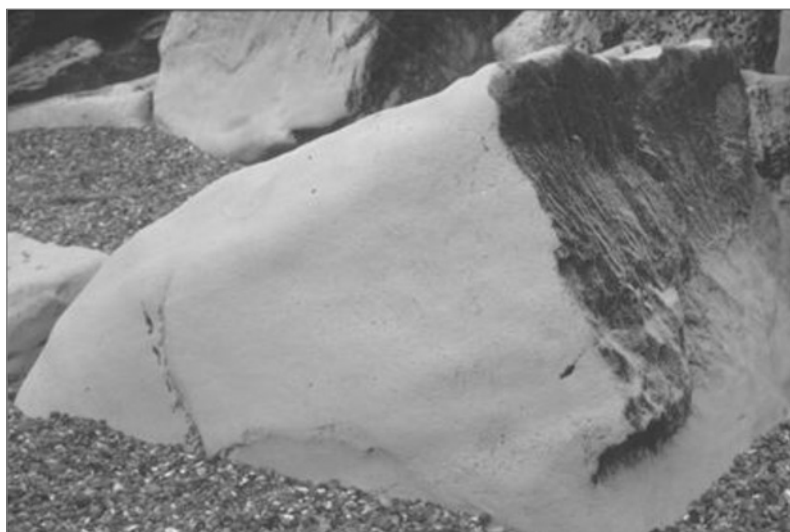
Figure 3.12 Érosion et perte de masse rapides de blocs de calcaire oolitique, liées à l'action abrasive des galets (source : J.-P. Latham)
