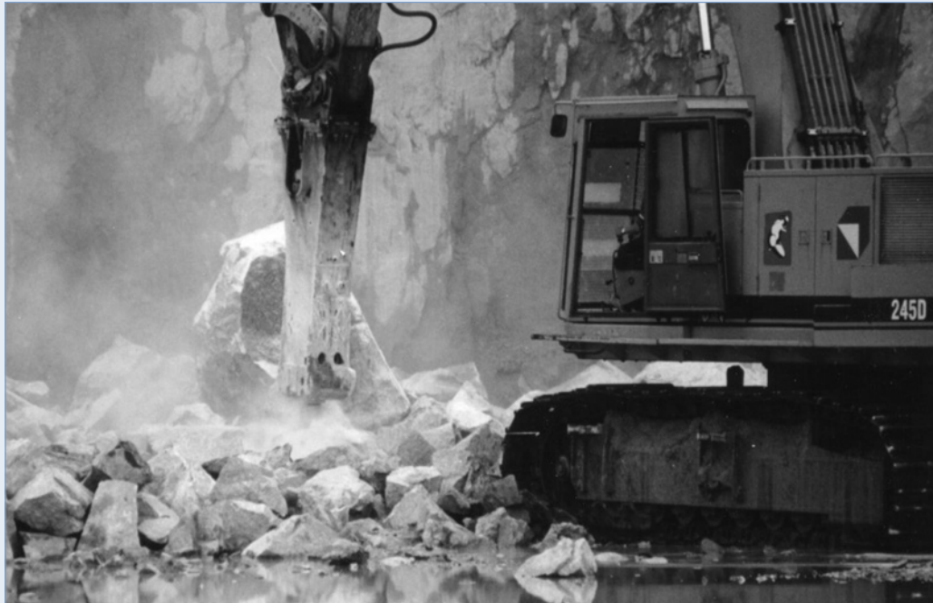
Figure 3.76 Pelle hydraulique équipée d'un BRH de 3.5 t
