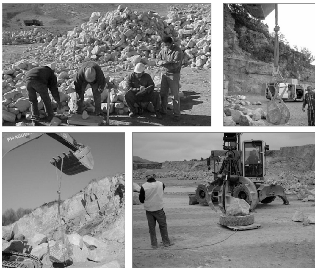
Figure 3.85 Contrôle de la blocométrie sur le site de la carrière avant les livraisons. En haut à gauche : contrôle d'enrochements moyens, supervisé par les représentants de l'acheteur et du producteur (source : J. van Meulen) ; en haut à droite : contrôle de petits enrochements à l'aide d'un grappin portatif (source : J. Perrier) ; en bas à gauche : contrôle de petits enrochements à l'aide d'un filet portatif (source : J. Perrier) ; en bas à droite : contrôle de gros enrochements à l'aide d'une balance portative (source : A. Moiset)
