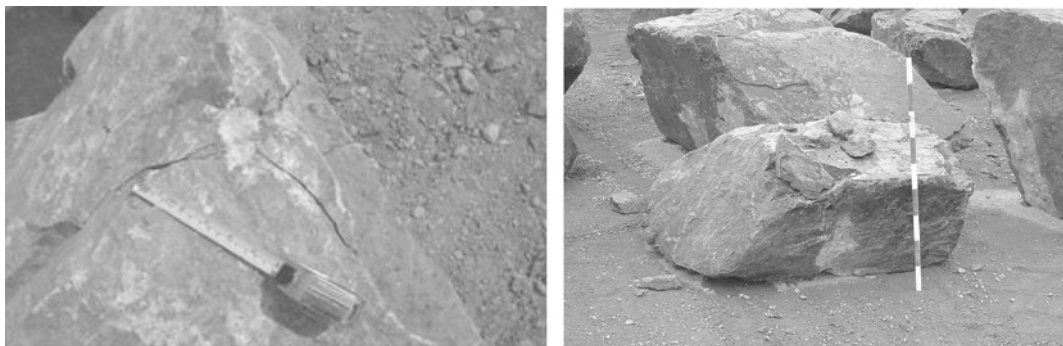
Figure 3.11 Exemples de rupture mineure observés dans des roches sédimentaires et ignées (source : S. Dupray)
