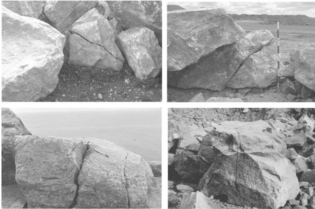
Figure 3.10 Exemples de rupture majeure observés dans des roches sédimentaires et ignées (source : S. Dupray et de G.J. Laan)
