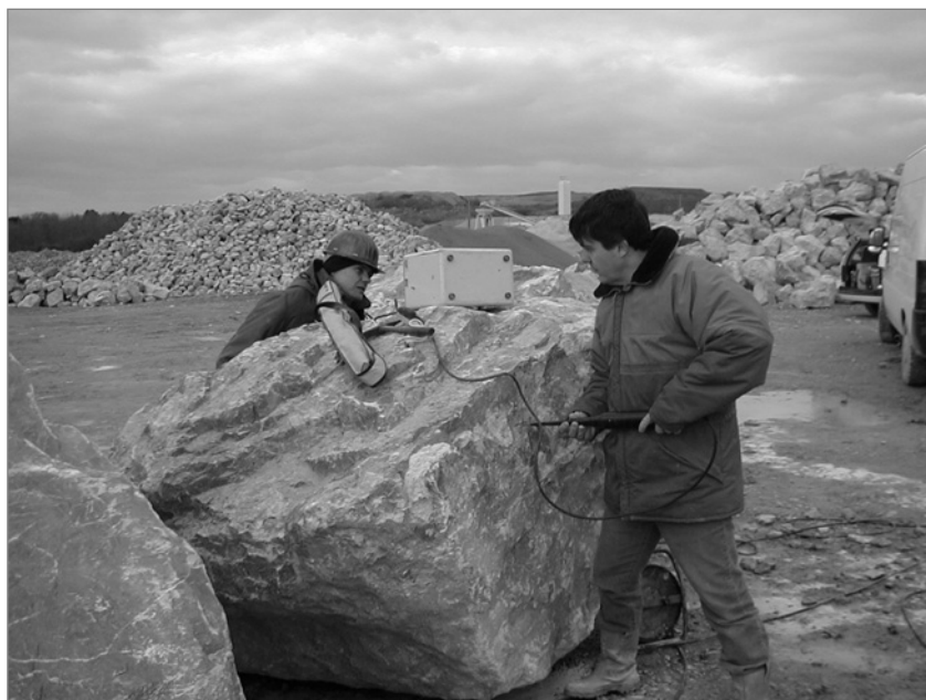
Figure 3.88 Contrôle de l'intégrité de gros enrochements à l'aide d'un appareil de vitesse du son. Noter la présence de stocks en arrière-plan (source : A. Moiset)
