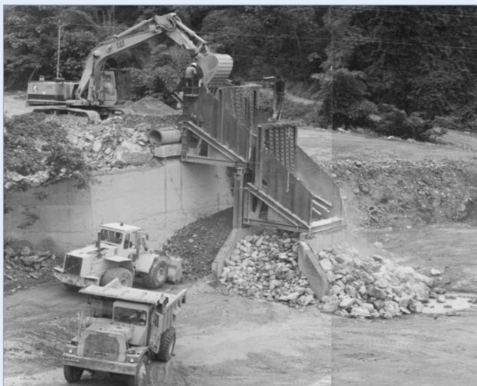
Figure 3.73 Vue d'une série de deux calibreuses destinées à produire des enrochements
