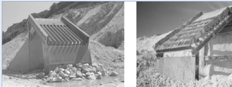
Figure 3.70 Barres statiques pour traiter les matériaux du noyau en enlevant les fines (à gauche) et barres statiques pour la production d'enrochements de moyenne et de petite taille (à droite)
