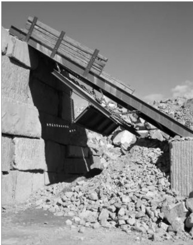
Figure 3.84 Grandes barres statiques pour la production de différentes tailles d'enrochements (source : S. Dupray)
