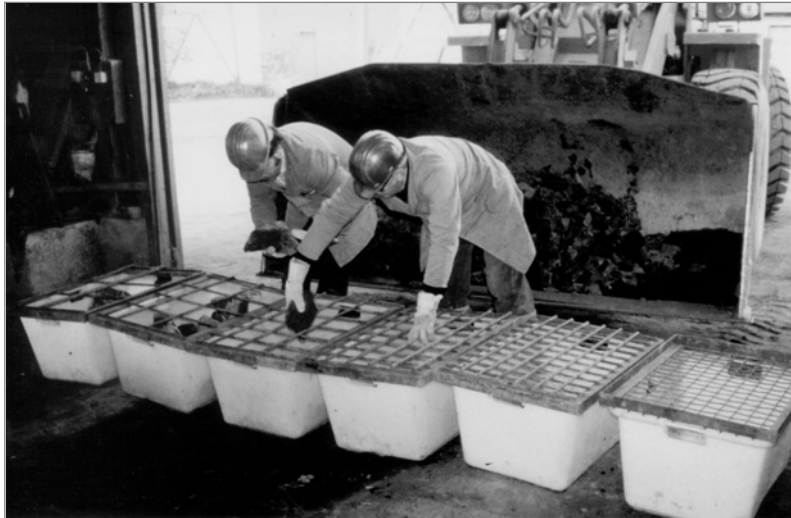
Figure 3.40 Tamis à fils d'acier utilisés pour déterminer la distribution granulométrique des petits enrochements (source : G. Laan)
