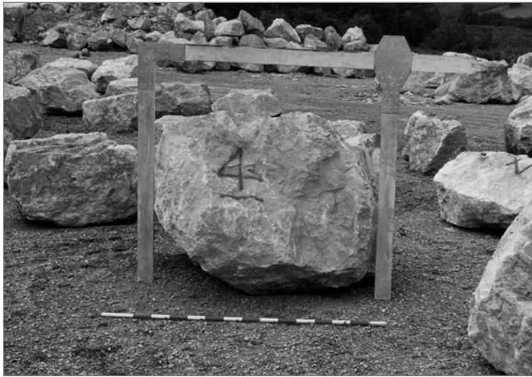
Figure 3.82 Utilisation d'un pied à coulisse pour mesurer l'élanement de blocs lors du contrôle de la qualité, et aussi pour le choix de blocs témoins utilisés pour le contrôle de la forme (source : A. Moiset)
