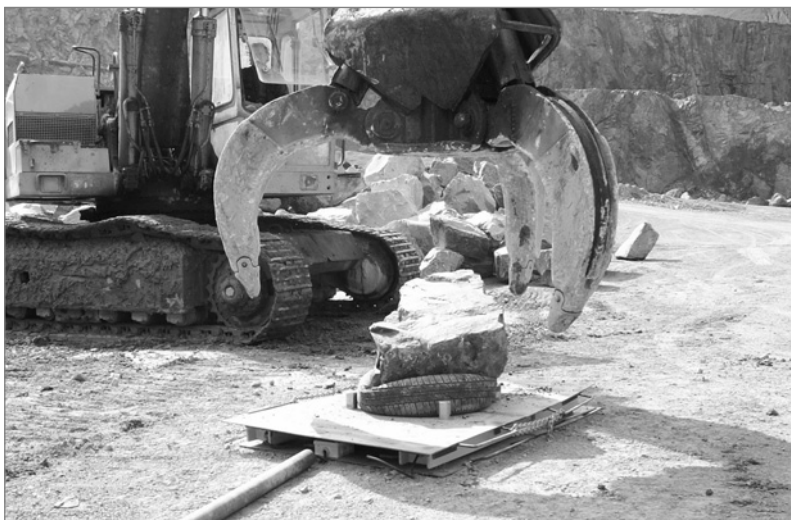
Figure 3.41 Cliché d'une bascule à haute capacité faite de poutre de pesée utilisée pour les blocs de masse inférieure à 6 t (source : S. Dupray)
