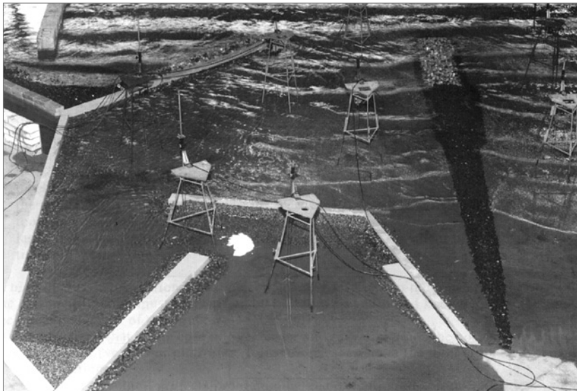
Figure 4.50 Modélisation physique des conditions de houle
