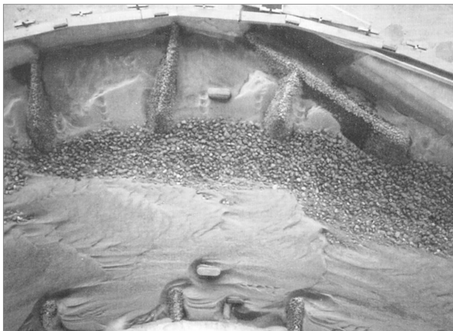
Figure 4.91 Exemple de modèle physique de rivière à un fond mobile
